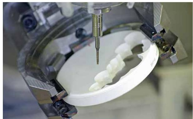
Microlavorazione per il settore della tecnica medica
