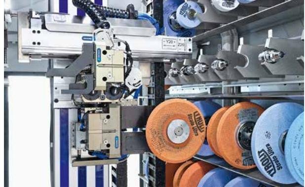
Cambio automatico delle ruote di rettifica
