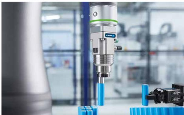
Manipolazione di celle cilindriche per batterie
