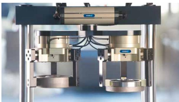
Manipolazione di pezzi grezzi e finiti
