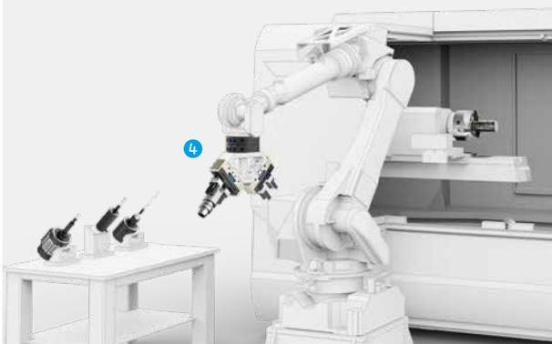
Caricamento di una macchina utensile con un robot a braccio snodato
