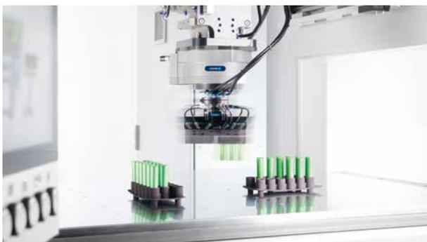
Manipolazione di celle cilindriche per batterie
