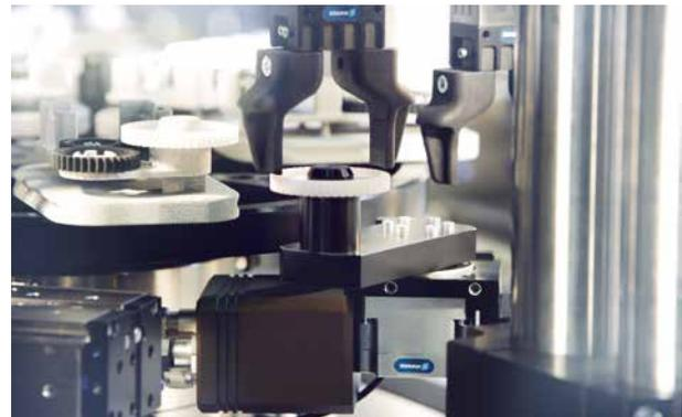
Assemblaggio degli ingranaggi
