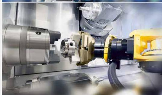
Unità di compensazione e anti-collisione
