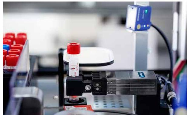
Manipolazione e tenuta delle provette per il prelievo di sangue
