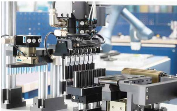
Manipolazione di celle cilindriche per batterie
